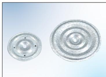
エアツール方式専用のプレートでエアピンと組み合わせて使用します。プレートの裏面の4ヶ所の突起（ツメ）がシートに均等にくい込んで、強固に固定します（エアプレート75、IHを除く）。
