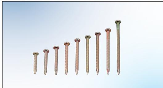
エアプレートと同時に用いるエアツール方式専用アンカーです。圧縮空気を利用したネイルマシンを使用してRC下地に瞬時に打ち込み、コンクリートの圧縮力で強度を有します。
